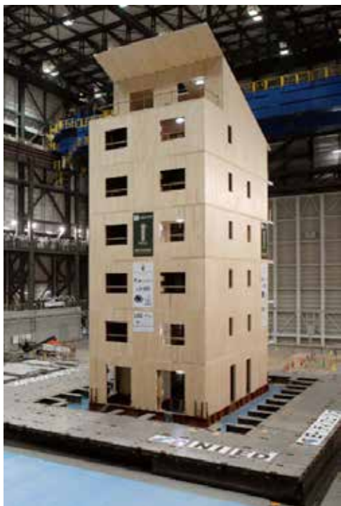
Progetto Sofie (Ivalsa) durante le prove di antisismicità
