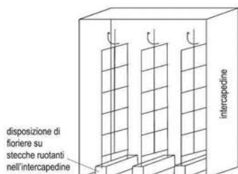
Fig. 1 - Installazione di piante nell'intercapedine della facciata attraverso la loro disposizione in fioriere su stecche ruotanti. (Fonte: W.G. Stec, A.H.C., Van Paassen, A. Maziarz. Disegno rielaborato dall'autore.)
